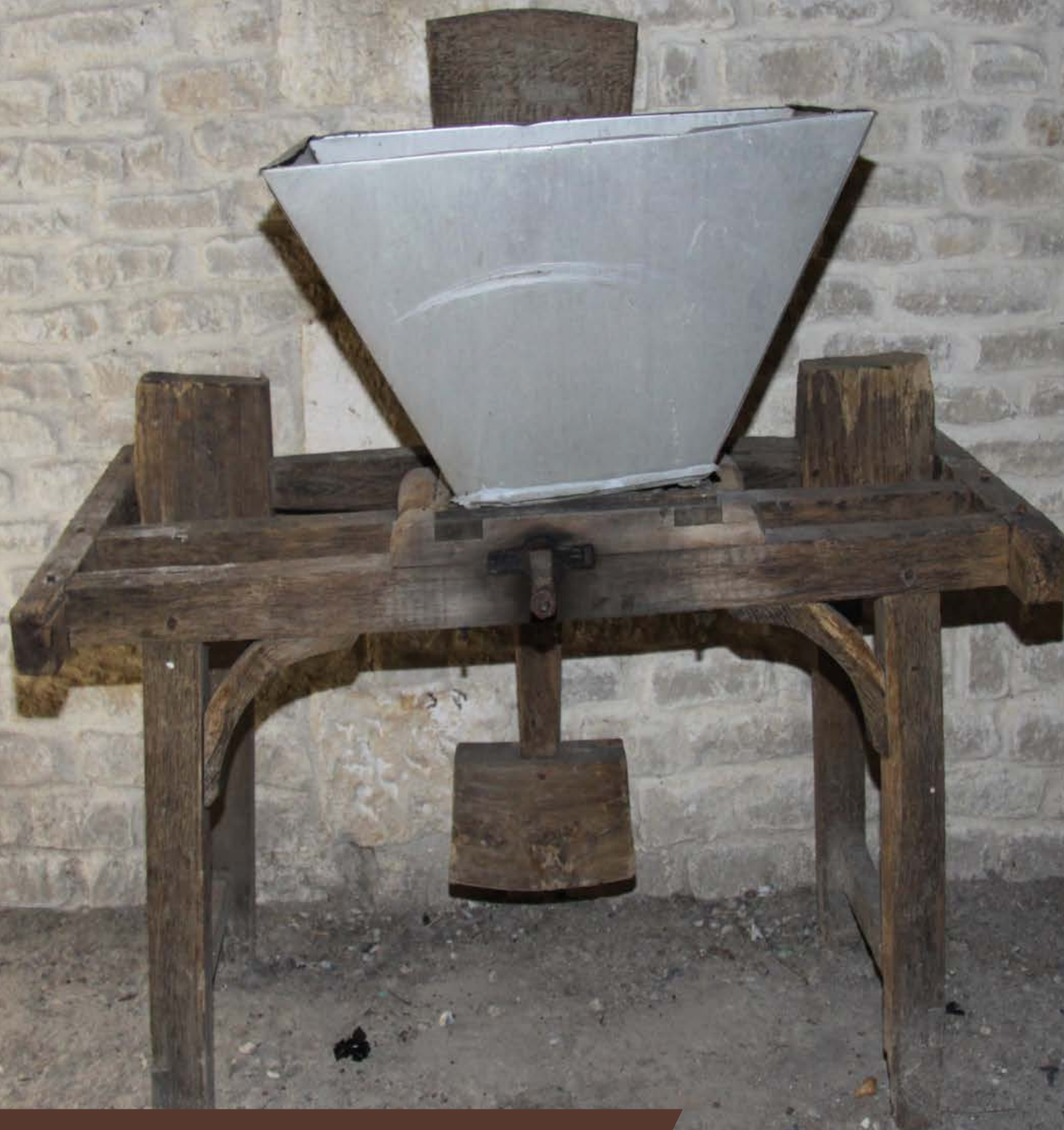
Machine broyant les pommes pour remplir de jus les tonneaux de bois.
